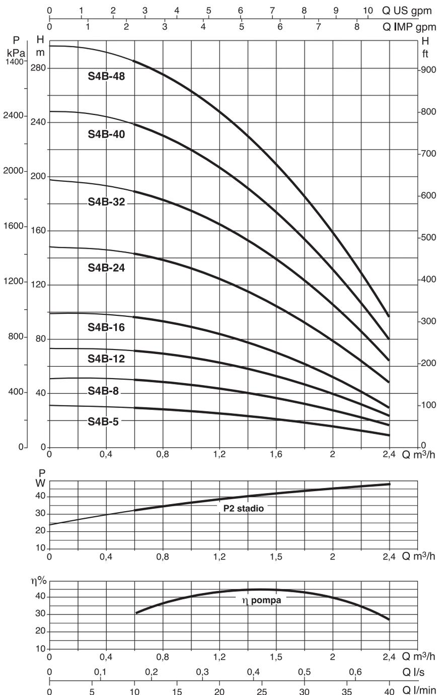
Prestazioni a 50 Hz 2 poli. Le curve di prestazione sono basate su valori di viscosità cinematica = 1 mm²/s e densità pari a 1000 kg/m³. Tolleranza delle curve secondo ISO9906.
