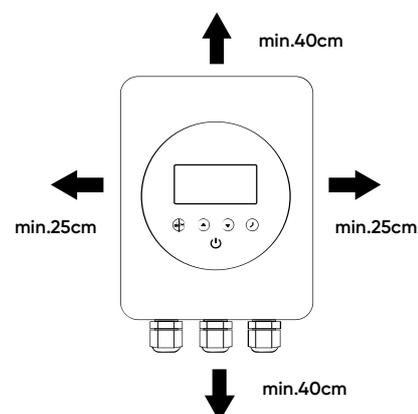
Marquer l'emplacement des perçages au mur selon le plan fourni dans l'emballage. Percer les trous, insérer les chevilles fournies et visser les vis fournies en les laissant dépasser de 12mm.
