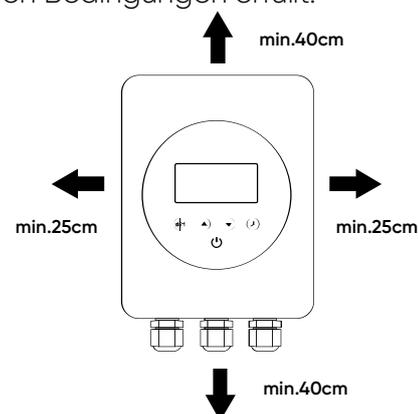
Bohrlöcher an der Wand markieren, bohren und die im Lieferumfang enthaltenen Dübel einsetzen, Schrauben einschrauben und das Gerät an den Schrauben aufhängen.
