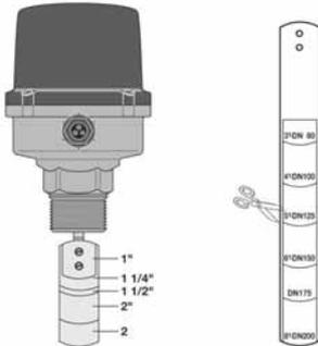
Le flussostat doit être monté sur la tuyauterie si possible à l'horizontale, en respectant le sens du flux indiqué par la flèche placée sur le couvercle et à l'extérieur du corps. Pour que la lamelle fonctionne correctement, le flussostat doit être monté à la hauteur indiquée sur le dessin.
