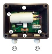
voyant d'état : (1) fixe: fonctionnement normal 🔅 🔼 : clignotant : manque d'eau 2 x 🍅 🔥 : 2 clignotements rapprochés : défaut électrique Condensateur de démarrage DUCATI ® Bornier de raccordement «commande» Bornes de terre (c) Bornier de raccordement «pompe» Presse-étoupe raccordement Presse-étoupe raccordement (P1) «commande»
