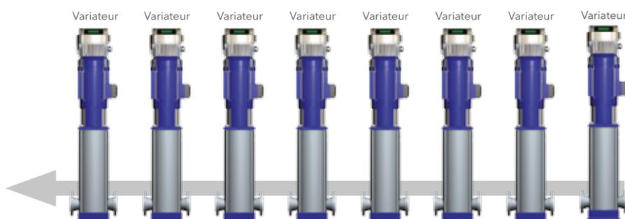
Modes multi-contrôleur, relais cascade : dans ce cas vous pouvez installer un HYDROVAR et jusqu'à cinq pompes esclaves à vitesse fixe qui sont mises en marche ou arrêtées selon la demande. L'utilisation de ce type de fonctionnement nécessite une carte Premium et un coffret de commande externe.
