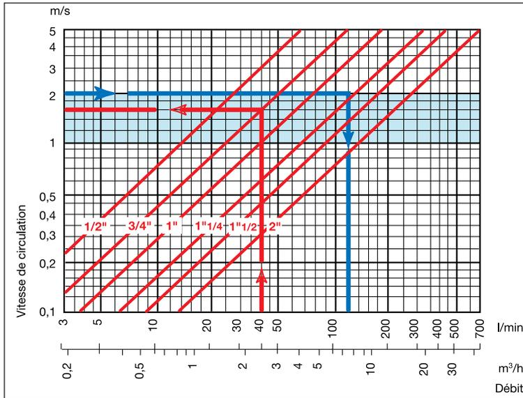
**Exemple de calcul d'un réducteur de pression (diagramme A).**
