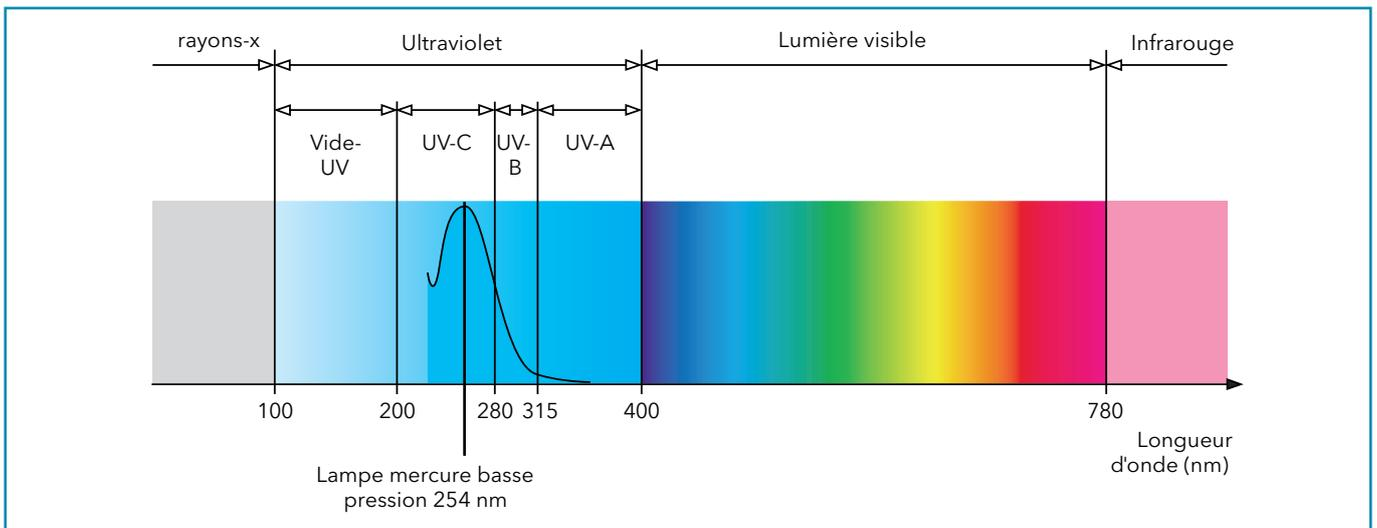
La lumière ultraviolette, correspondant aux longueurs d'onde des UV-C, a la propriété unique de détruire les micro-organismes (tels que les virus, les bactéries et les protozoaires) présents dans l'eau ou dans l'air, en les empêchant de proliférer et de causer des infections ou des maladies.
