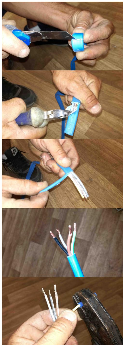
n'est pas parfait ou si l'un des fils ne tient pas (le courant qui traversera la cosse mal sertie risque de provoquer un échauffement important et de créer une chute de tension, pouvant entraîner une dégradation totale du moteur immergé)
